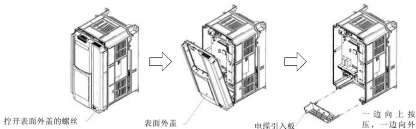
图 2.5 表面外盖和电缆引入板的拆卸
